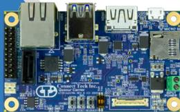
"Quasar"は、NVIDIA TX2 / TX2 4GB / TX2i / TX1のための最新キャリアボードです。人気のOrbitty キャリアと非常によく似ていますが、この製品は87mm x 50mmの設置面積を維持しながら、いくつかの新機能が追加されています。
