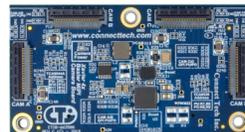
"4x Basler MIPI Camera Board"は、最大4台のBasler社 dart カメラをJetson Xavier モジュールに接続できる拡張ボードです。Rogue carrier用に設計されていますが、NVIDIA® Jetson AGX Xavier™ 開発キットとも互換性があります。
