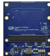
アダプター"Mimic"はNVIDIA® Jetson™ AGX Xavier™ モジュールをNVIDIA Jetson TX2/TX2i/TX1 キャリアに取り付けることを可能にします。この製品は、既存のTX2/TX2i/TX1設計の性能と新しいAGX Xavierを比較しやすいユーザーに最適です。
