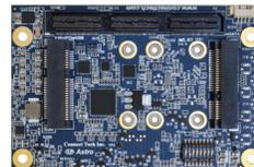
"Astro"は、NVIDIA® Jetson™ TX2/TX2i/TX1 モジュール用に設計されています。
