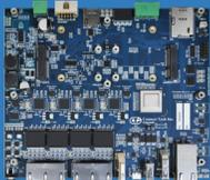
NVIDIA® Jetson™ TX2/ TX2i/ TX1用の"Cogswell" キャリアは、GbEビジョンアプリケーションでの使用に最適です。この製品は、GbEビジョンカメラに適したPoEによる給電機能が組み込まれたGbEチャンネルを提供します。
