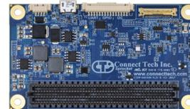
"Sprocket" キャリアは、NVIDIA® Jetson™ TX2/TX2i/TX1 モジュールフォームファクタ用に設計されています。
