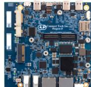
"Rogue-X Carrier"はXavierモジュールが最大2台のXIMEA社製組み込みビジョンカメラ"xiX"を搭載することを可能とし、各カメラは4つのPCIe Gen2接続を利用可能です。また、この製品はUSB3.1 x3, GbE x2, HDMI x2, ロック可能なMini-Fit Jr.電源入力コネクタが利用可能です。
