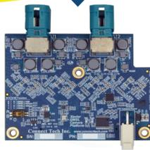
"Xavier GMSL2 Camera Platform"は、最大で8台のGMSL2/1カメラ入力をサポートします。Rogue Carrier(PN:JCB002)用に設計されていますが、NVIDIA® Jetson AGX Xavier™ 開発キット (PN:JCB004)とも互換性があります。
