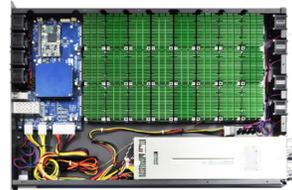
拡張性のあるArray Serverの3つのアレイボードには、それぞれ8つのNVIDIA® Jetson™ TX2/TX1モジュールが収容されており、計24個のモジュールすべてがGbEファブリックを介して、10Gアップリンク機能を備えた専用のマネージドイーサネットスイッチへ接続されています。
