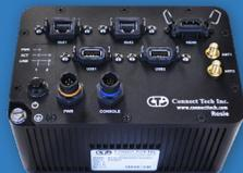
"Rosie"は、NVIDIA® Jetson™ TX2/TX2i / TX1をベースにした小さなフォームファクターの堅牢な組み込みシステムです。オプションのブラケット付きの堅牢でコンパクトな筐体に収納されたこの製品は、革新的なNVIDIA Pascal™/Maxwell™ アーキテクチャを搭載しています。
