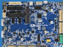
NVIDIA® Jetson™ TX2/ TX2i/ TX1用の"Spacely" キャリアは、無人車両アプリケーションや状況認識が重要なアプリケーションに最適な製品です。この製品は、最大6台のMIPI CSI-2カメラを同時に接続できます。
