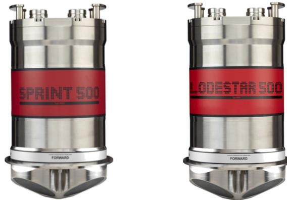
SPRINT-Navは、AHRs 姿勢方位基準装置と INS 慣性航法装置、Syrinx DVL ドップラー速度ログ、高精度圧力センサーを一つのハウジングに、一体化することにより、水中ビークルとサーベイ作業にオールインワンのナビゲーションを提供しています。Loadstar-Navは、上記からINS機能を除いた機器です。市販品では、最小の複合慣性ナビゲーション機器となっています。
