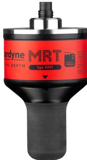
Micro-Ranger トランシーバー (MRT) は、超短基線 (USBL) を使った、軽量で、イーサネットとのインターフェースを持つ、トランシーバーであり、Sonardyne の 6G ビーコン製品をサポートします。サイズが小さいため、扱いが楽であり、イーサネットを介した電力で稼働します。MRT は、Micro-Ranger2 システムが使用されるイーサネット シリアル ハブ (ESH) に接続します。浅海域、深海域に関わらず、995メートルまでのトランシーバーの位置を決定できます。
