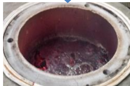
プラズマ溶融によるガラス固化と減容化例
