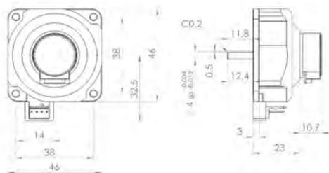
※ モータベース側に3-M3 PCDφ28 深さ3.5mmの取付けネジ穴あり
