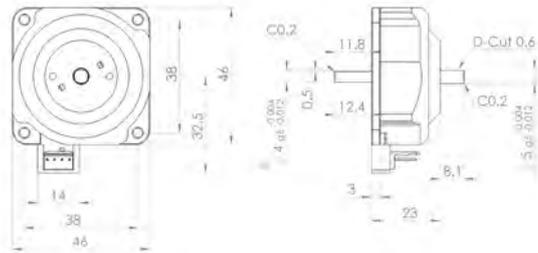
※ モータベース側に3-M3 PCDφ28 深さ3.5mmの取付けネジ穴あり
