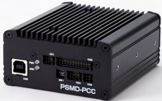
PSMD-SPCの機能に加え、PCとUSB接続、SPI通信により外部からモータの回転方向、速度を直接操作するデジタルコントロールが可能なモデル。
