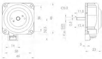
※ モータベース側に3-M3 PCDφ28 深さ3.5mmの取付けネジ穴あり
