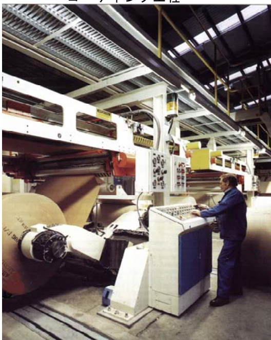
コーティング工程
