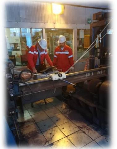
デモにてレール表面横方向、長手方向のノッチ両方を各々のプローブにて探傷。
