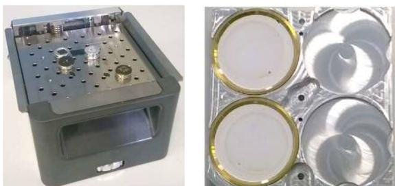
図2 試料ホルダ、及びホルダをセットしたステージ（右側）
