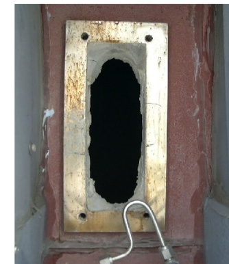
検出器外面には ダストが付着しても、検 出部の汚れは 無し
