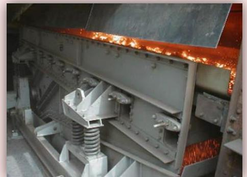
HOTスクリーンは最高1000℃の原料に対応し、大型スクリーンのサイズは幅 4,000~4,500 mm、有効全長 9,000~9,700 mm前後、最大処理量は 3,000~4,000 ton/h可能です。
