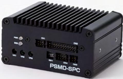
2本のTTL信号でモータの回転方向を、0 ~ 3.2[V]のアナログ電圧でモータの速度を制御可能なアナログコントロールモデル。
